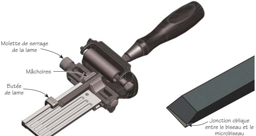
Figure 5: Jonction oblique entre le biseau et le microbiseau
